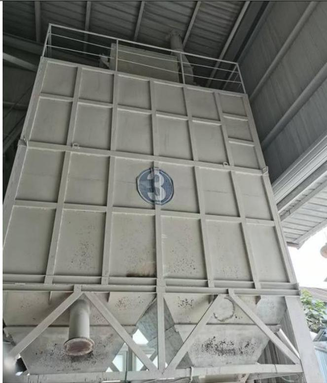
图 3-3 一号产品储罐及仓顶除尘器
