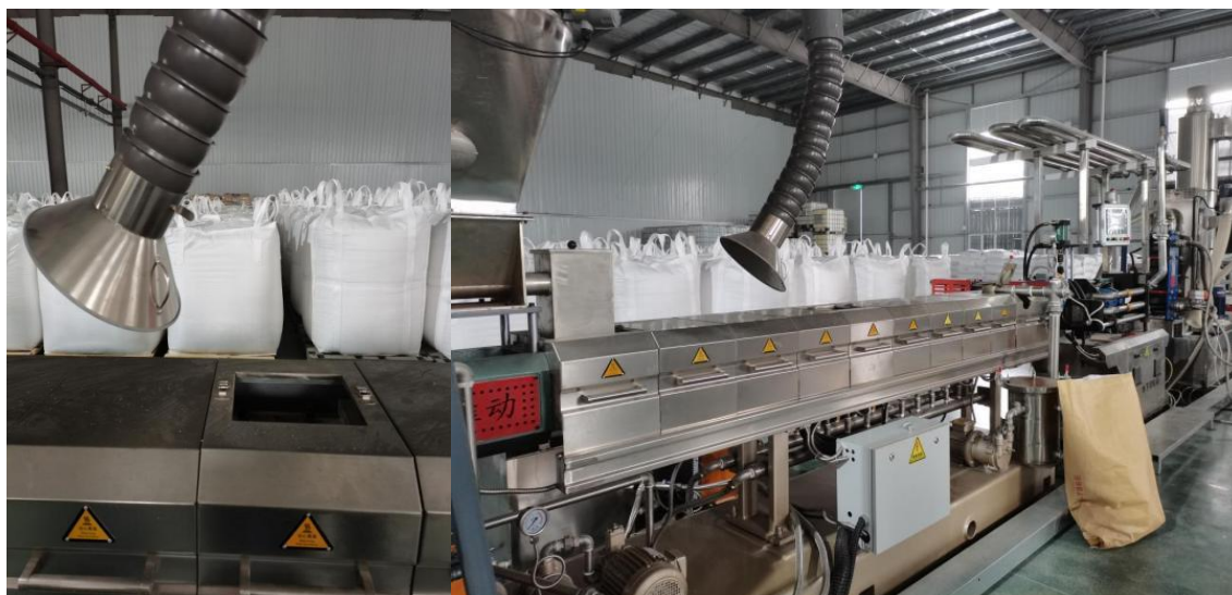
图 3-6 水下切粒熔融、挤出过程封闭原排气口及废气收集装置
