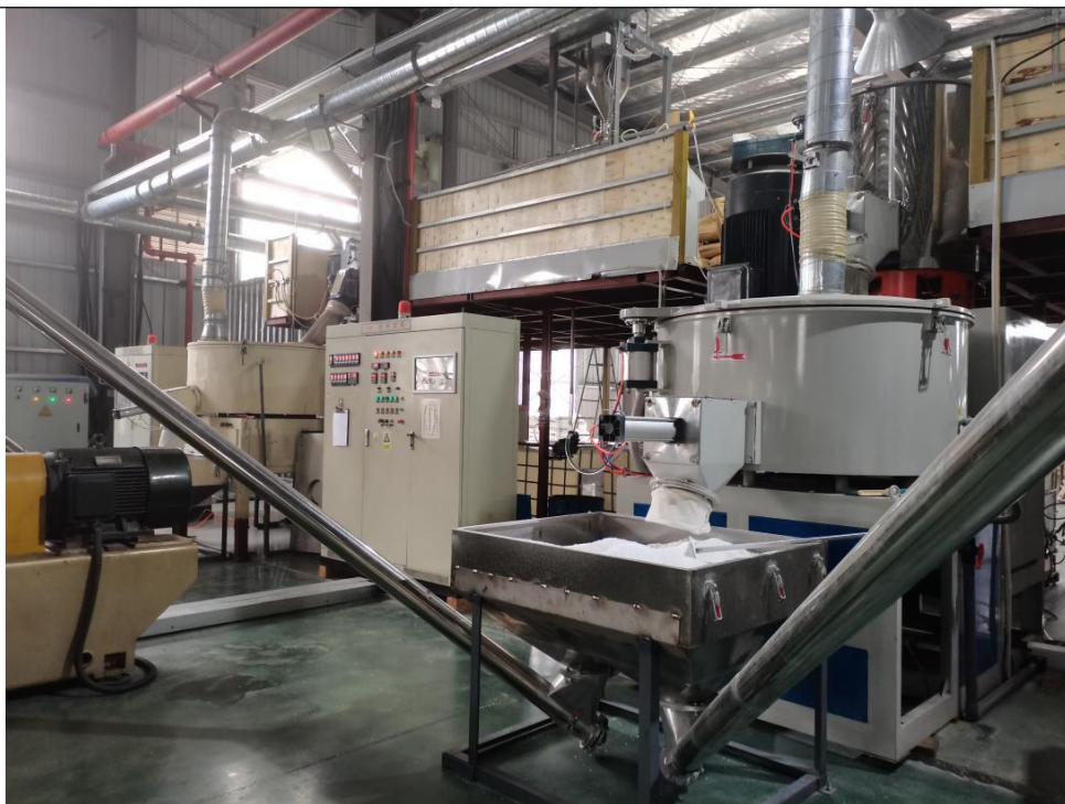
图 3-2 备料磨粉、解包、投料、冷却出料过程废气收集措施
