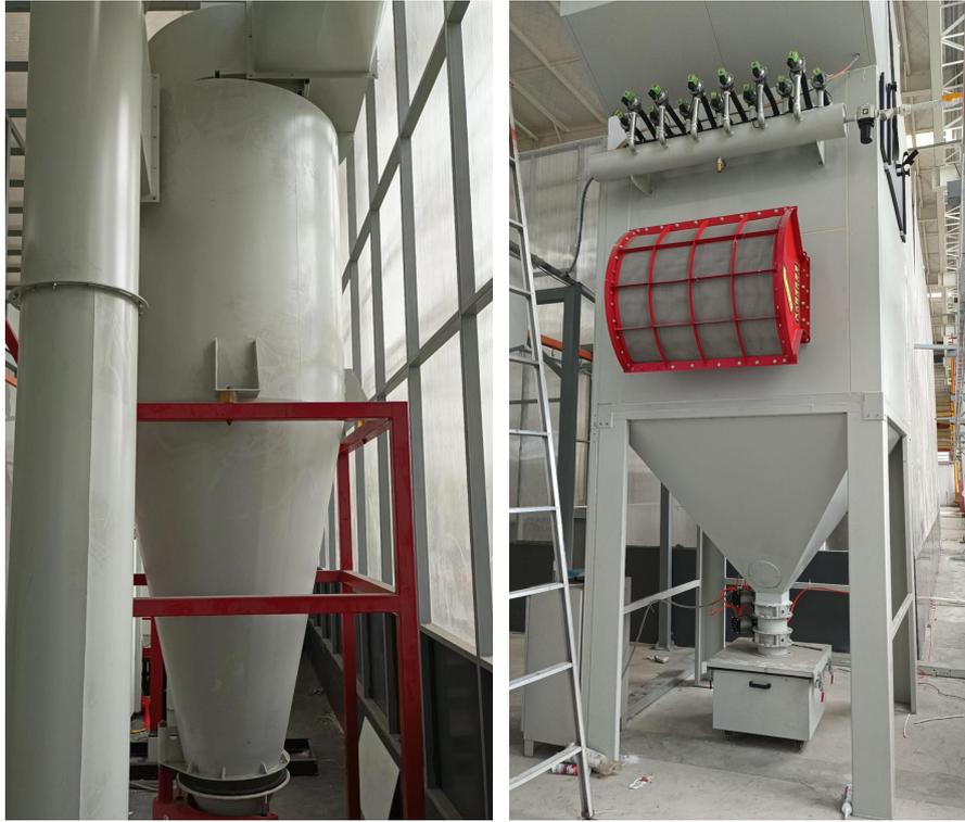
图 4-2 1#喷粉废气处理设施
