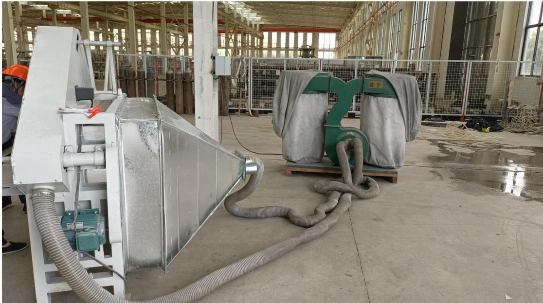
图 4-7 打磨工序废气收集及处理设施
