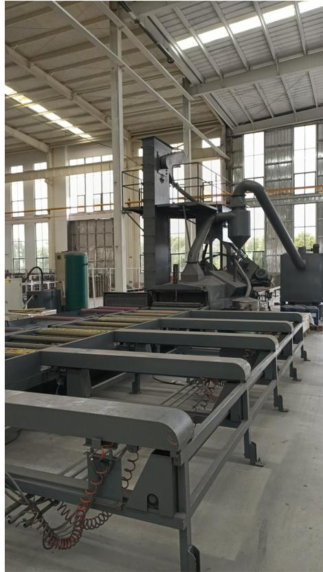
图 4-8 喷砂打磨工序废气收集及处理设施
