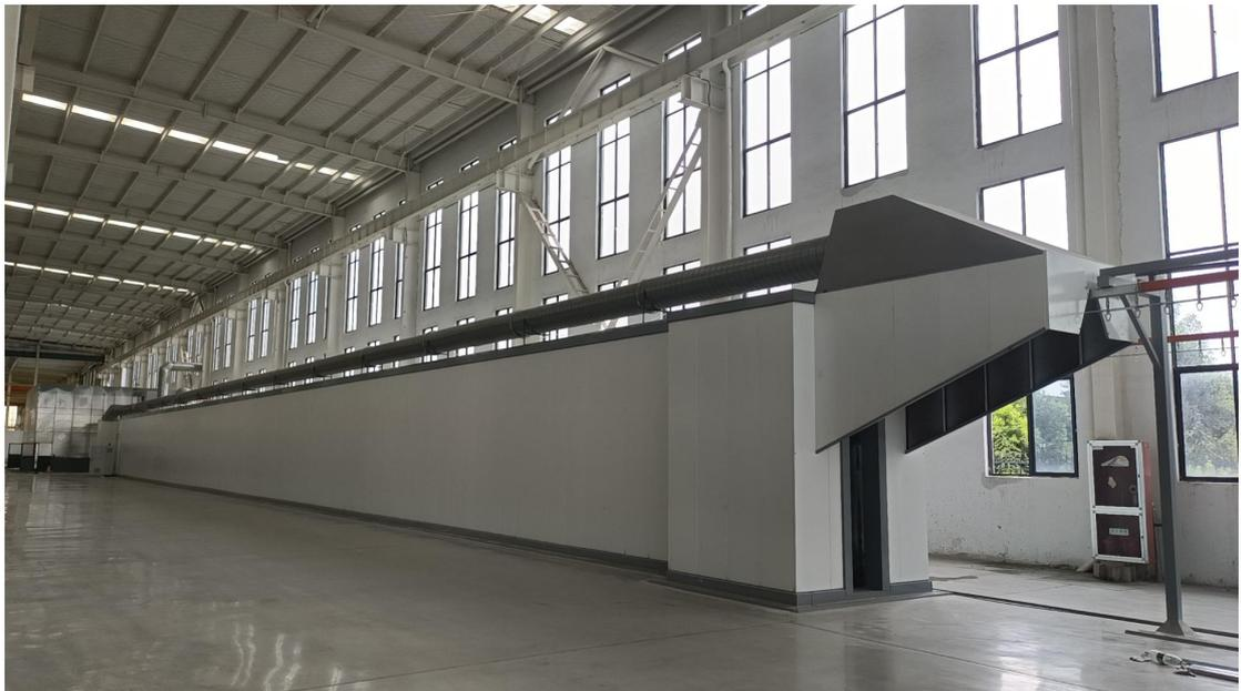
图 4-5 1#固化工序废气收集及处理设施
